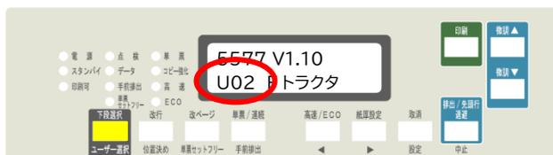
図の場合、プリンター側がユーザー2の状態なので、設定移行ツールで作成した設定を送信すると、プリンターのユーザー2に登録されます。プリンターのユーザー切り替えは印刷不可状態で「ユーザー選択」スイッチを押下して行います。詳しくは「設置操作ガイド」の「第4章 操作パネルと印刷の基本操作」をご参照ください。
