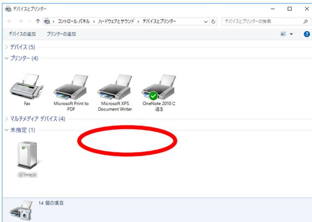
5. [コントロールパネル]–[デバイスとプリンターの表示]を選択します。この時、検出されたプリンターのモデル名は[未指定]のままとなっています。この画面上にあるデバイス以外のスペースで右クリックし、[デバイスマネージャー]を選択します。
