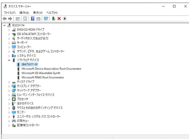
6. [デバイスマネージャー]の[ソフトウェア デバイス]もしくは[ほかのデバイス]—プリンターのモデル名を右クリックし、[ドライバーソフトウェアの更新]を選択します。
