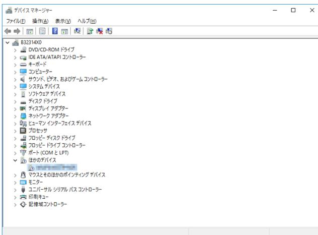
6. [デバイスマネージャー]の[ほかのデバイス] – プリンターのモデル名を右クリックし、[ドライバーソフトウェアの更新]を選択します。
