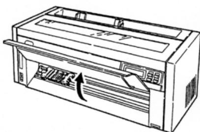
2. 用紙をトラクターにセットしてから、固定レバーを倒してトラクターをロックします。
