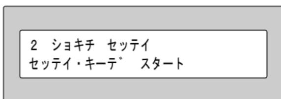
2. 設定スイッチを押し、次項目または前項目スイッチを押して、変更するメニューを選択します。
