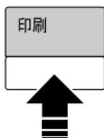
2. 高速印刷スイッチを2秒以上押します。
