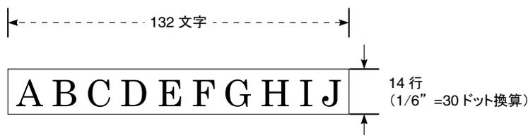
水平方向のドットを1ドット毎に間引くことにより、仮想的にイメージ・バッファーの容量が倍となります。従ってイメージ・バッファーの行方向Yは14行となり、16倍文字をすべて打つことができます。
