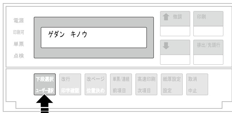
**2** 次項目スイッチを押して「1 オフライン インサツ」を選択し、設定スイッチを押します。
