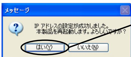
設定したIPアドレスを有効にするために本製品をリセットします。「はい」をクリックしてください。
