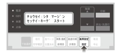
下マージンの移動量を選択し、設定スイッチを押します。 次項目あるいは前項目スイッチを押して、移動量を増減します。
