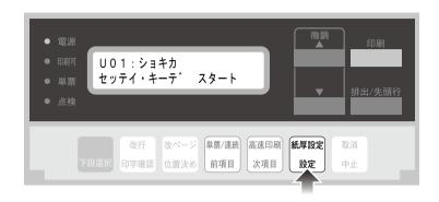
次項目あるいは前項目スイッチを押して、「ジッコウ」を選択(初期化を中止する場合は「トリヤメ」を選択)し、設定スイッチを押します。
