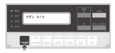
次項目あるいは前項目スイッチを押し、「4 チョウセイ」を選択し、設定スイッチを押します。
