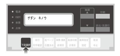
文項目スイッチを押して、「1 オフライン インサツ」を選択し、設定スイッチを押します。
