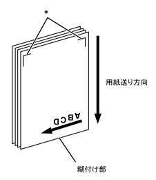
図中の\*部に糊付けが無い用紙を自動給紙モード (ASF) で使用する場合の排出方向は、下方向にしてください。
