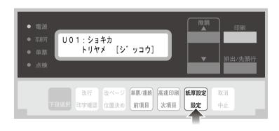
**5 3** の表示に戻ったら印刷スイッチを押し、初期化を終了します。 初期診断テストが実行されます。
