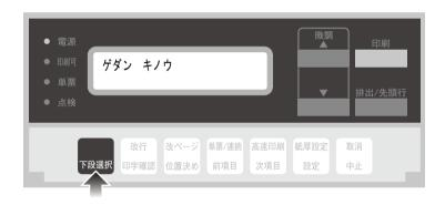
2 ユーザー設定を初期化する場合は「2 ユーザー セッテイ」を、共通設定を初期化する場合は「3 キョウツウ セッテイ」を選択し、設定スイッチを押します。
