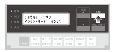
9 印刷スイッチを押して、単票下マージン調整を終了します。 初期診断テストを実行します。
