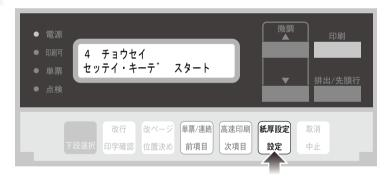
次項目あるいは前項目スイッチを押し、「チョウセイ:チョウセイ インサツ」を選択し、設定スイッチを押します。
