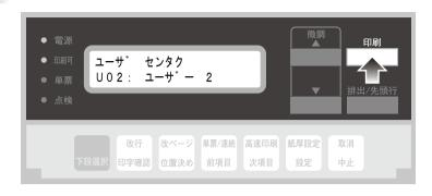
印刷スイッチを押すと、以下のような表示に変わり、印刷可能状態になります。
