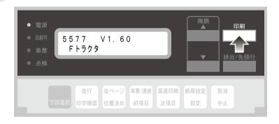
・2 下段選択スイッチを2回押します。 ユーザー選択画面が表示されます。
