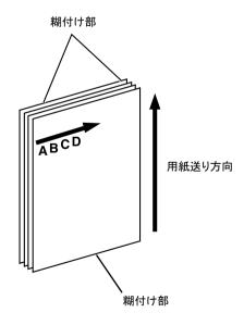
● 下向き印刷では、用紙を下方に送りながら文字列を180°回転させて印刷します。
