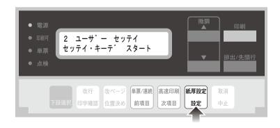
3 「設定値一覧」(4-24ページ)を参照しながら、次項目あるいは前項目スイッチを押して、設定を変更するメニューを選択し、設定スイッチを押します。
