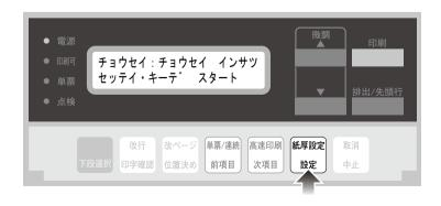
**4** 単票用紙をセットし、印刷スイッチを押します。
