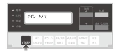
2 次項目あるいは前項目スイッチを押して、「2 ユーザー セッテイ」を選択し設定スイッチを押します。
