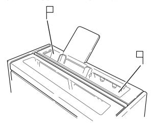
このようにセットすると、用紙の両端より約6.4 mmの内側は常に印刷可能な範囲となります。 ただし、1行に印字できる文字数はソフトウェアによって異なり、印刷可能な範囲は最大約345 mm (13.6インチ)です。
