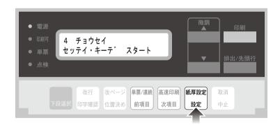
次項目あるいは前項目スイッチを押し、「チョウセイ:チョウセイ インサツ」を選択し、設定スイッチを押します。
