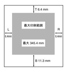
下向き印刷は、最大印刷可能な範囲はPマークと 「マークの間です。用紙を左に動かすときに注意してください。また、下向き印刷において、「マークを越えた所から印字しようとしても、実際には「マークからしか印字できませんので注意してください。
