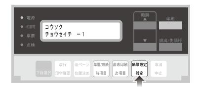
上の図は、最良パターンとして高速で「-1」を設定する例です。 もう一方の印字速度での罫線調整を行う場合には、**6** に戻って繰り返します。 取消キーで「チョウセイ:チョウセイ インサツ」に戻り、罫線パターンを印字します。
