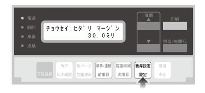
左マージン値は0.2 mm間隔で増減します。設定スイッチを押して、値を確定してください。 左マージン値の確定後、印刷スイッチを押すと、初期診断テストが実行されます。
