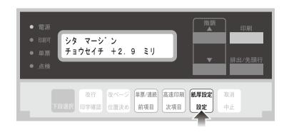
・7 下マージンの現在値を確認するときは、「チョウセイ:チョウセイ インサツ」を表示させ、 設定スイッチを押します。
