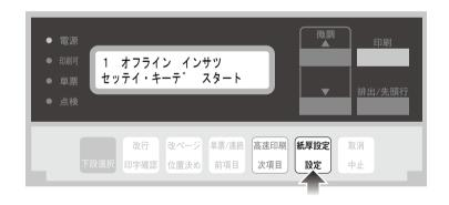
次項目あるいは前項目スイッチを押して、「ショキチ インサツ」を選択し、設定スイッチ を押します。
