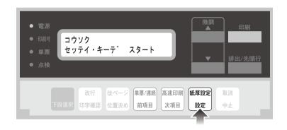
次項目あるいは前項目スイッチを押し、最良パターンの目盛を選択し、設定スイッチを押します。
