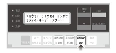
**8 印刷スイッチを押します。** 印刷結果が異なる場合は **6** (本ページ) に戻って設定し直します。
