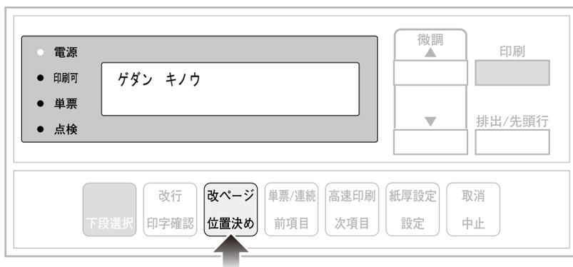
**Note** 単票モードで単票用紙がプリンターにない状態で位置決めスイッチを押すと、先頭行位置が用紙先端から約6.4 mm (4分の1インチ) の位置にセットされます。
